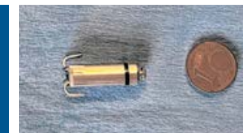
Diese Mikrokapseln, die von der Leiste aus direkt in der rechten Herzkammer verankert wird, ist heute der kleinste und modernste Herzschrittmacher. Er kann ohne Hautschnitt implantiert werden.
